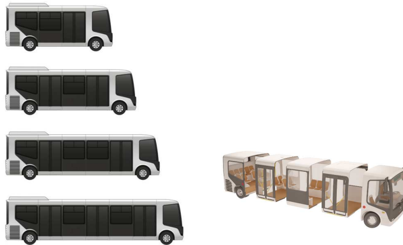
43. ábra Modulokból felépülő jármű
