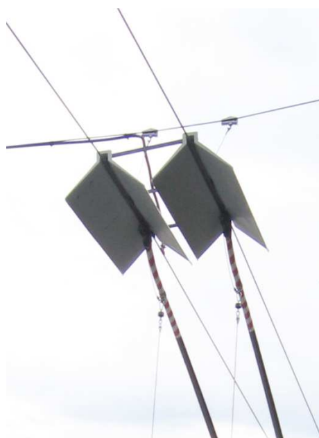
59. ábra Az áramszedő felengedését segítő terelőlemezek
