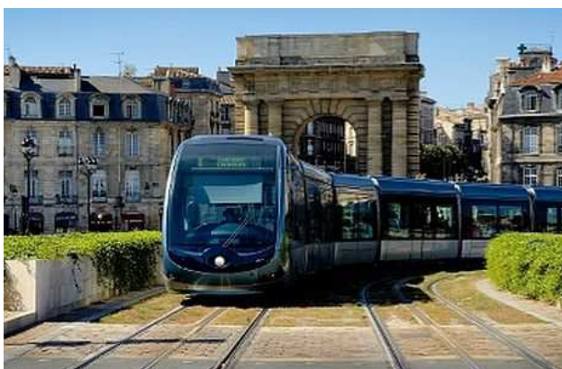
40. ábra Pályába épített energiaellátó rendszer (APS)
