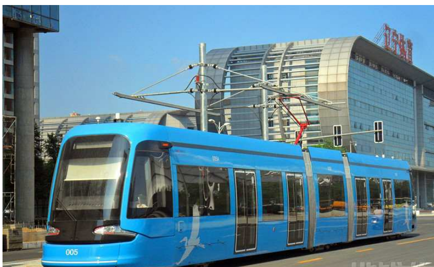
42. ábra Szuperkondenzátoros járművek töltése a megállóhelyknél
